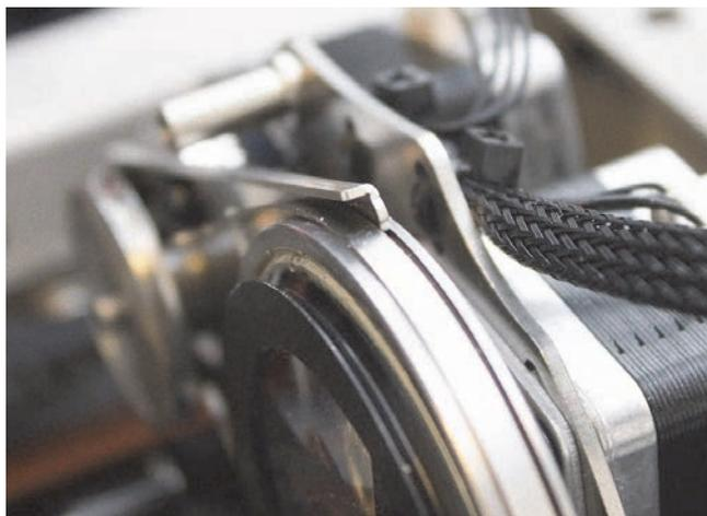
Figure 20: Placement correct du prisme
