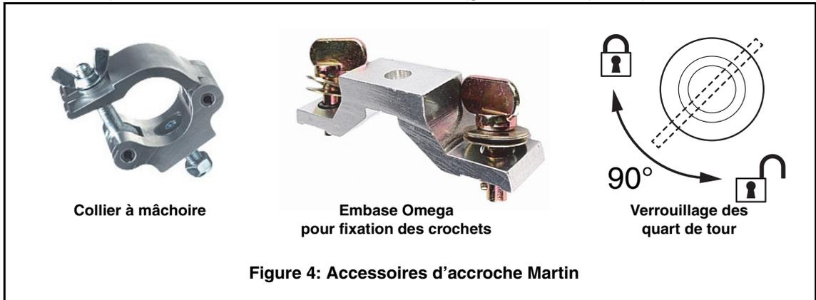
3. Voir Figure 5 en page 10. Alignez le premier ensemble crochet - embase avec les deux trous de fixation dans la base et engagez les deux verrouillages à quart de tour. Voir Figure 4. Tournez complètement les verrouillages de 90° dans le sens horaire pour les bloquer. Répétez la même opération pour le second ensemble crochet - embase.
