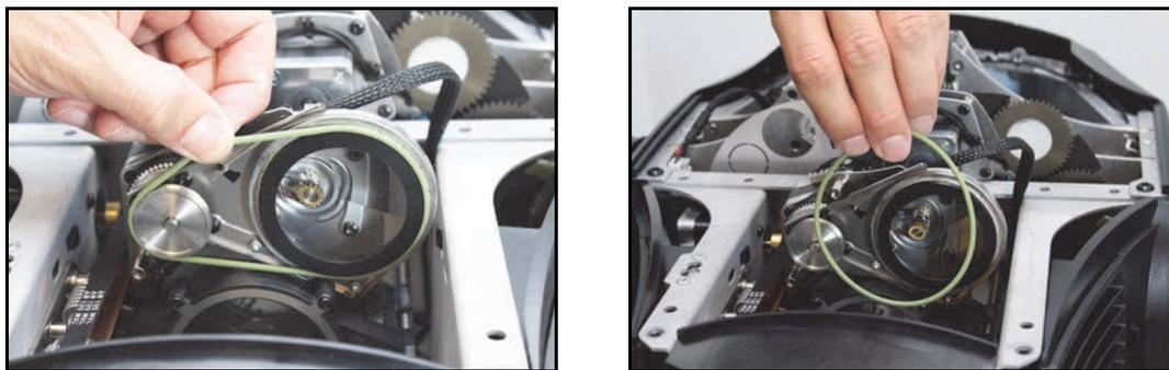
Figure 18: Dépose de la courroie du prisme
