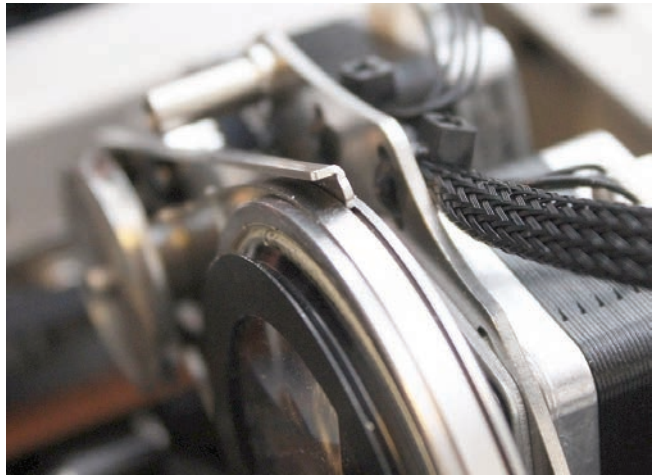
Bild 20: Sitz des Prismas in seiner Halterung
